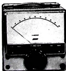
F-Meter 30 A direktanzeigender Frequenzmesser DM 299,-
